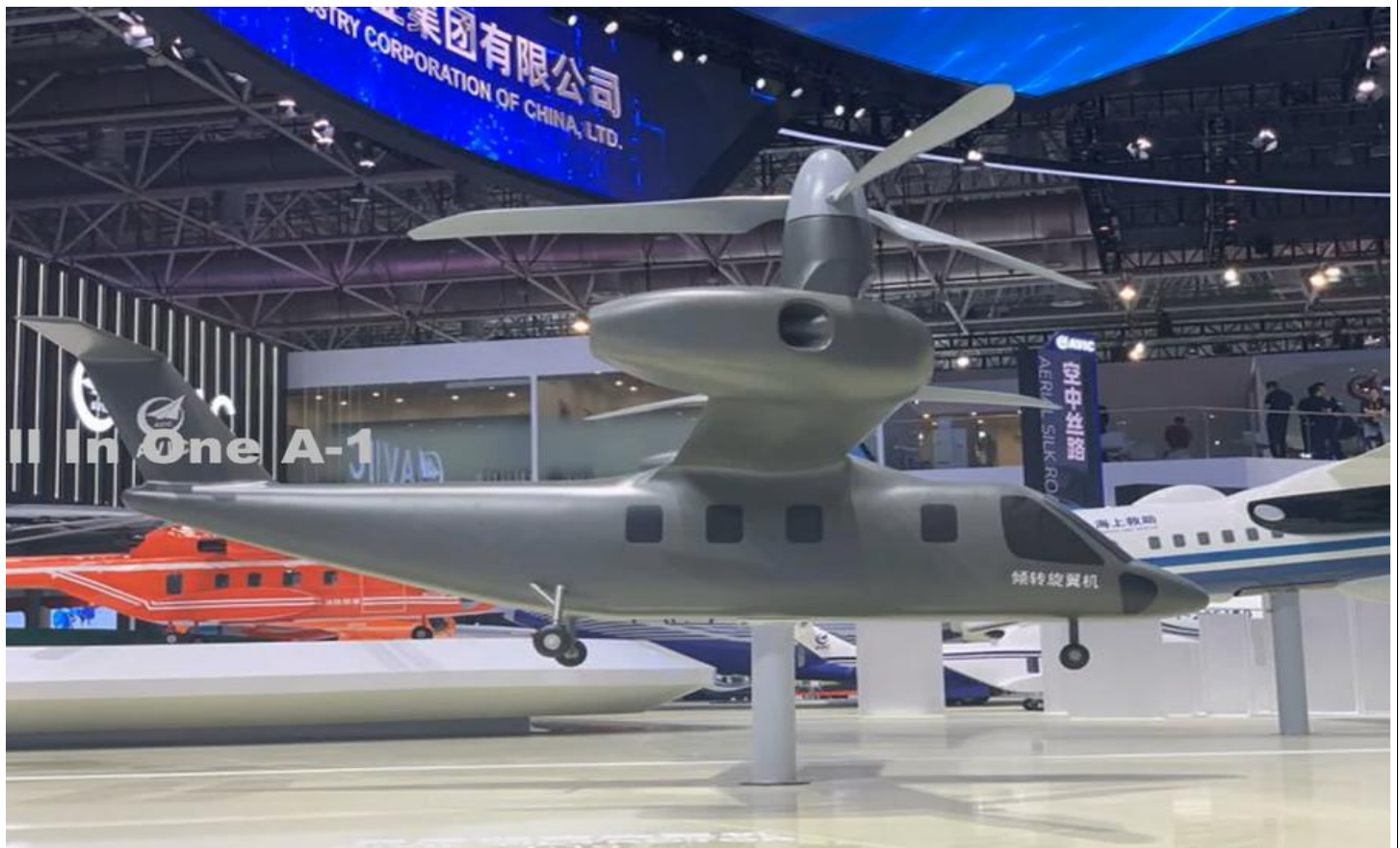
تصویر: موقعیت، فرم کلی شبیه AW609، اما راه تبدیل به هواپیما شبیه به V280
